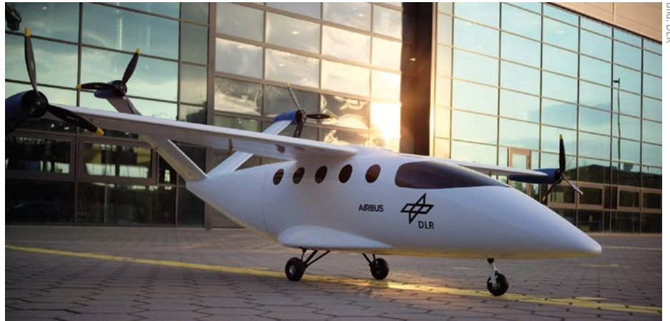
Skalierter, flugfähiger Demonstrator des HyBird im Maßstab 1:4 vor dem ZAL in Hamburg
