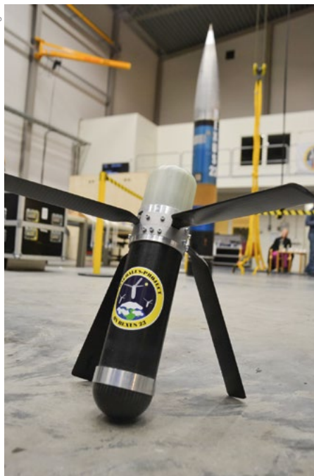
Das Prinzip der Autorotation sorgt dafür, dass Flugkörper aus großen Höhen um ein Vielfaches abgebremst werden und soll einmal Fallschirme bei Landekörpern aus dem Weltraum ersetzen. Erstmals wurde das Prinzip im Projekt Daedalus 1 verwendet.
